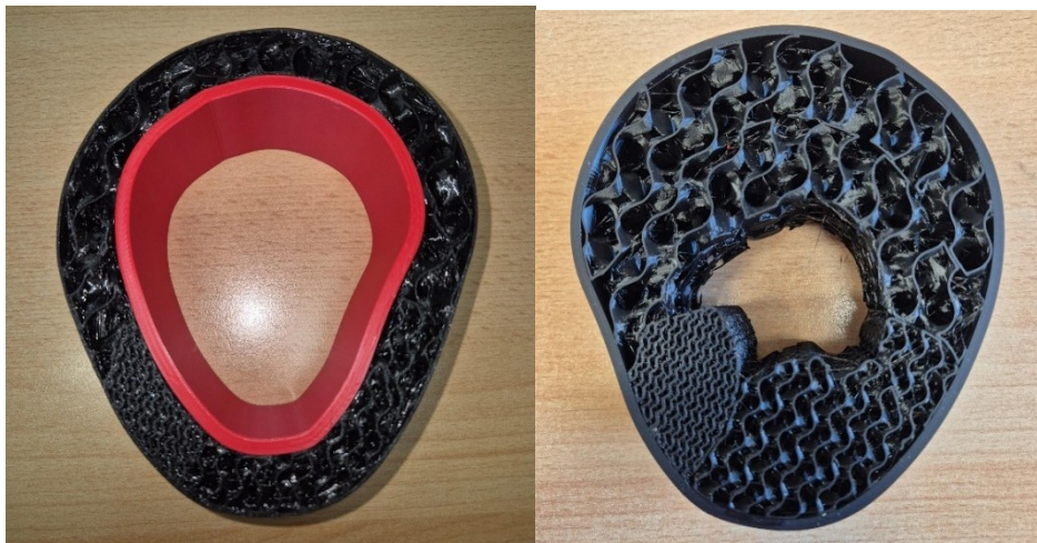
Fig. 3 Additiv gefertigtes weichen Segment eines Beines (a) Sichtbare Lagen für Knochenrepräsentation (Rot) und Weichgewebe, b) Segment für Weichgewebe mit drei unterschiedlichen Elastizitäten ausgeführt durch unterschiedliche Füllstrukturen
