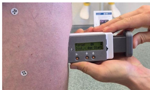
Fig. 4 Ermittlung der Elastizität des Weichgewebes und Eindringtiefe an einem Messpunkt mittels IdentoPRO Gerät.
