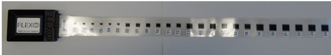
Fig. 6 Neuartiger Flexoo Sensor mit 24 Nasszellen, hier in Entwicklungsprototyp
