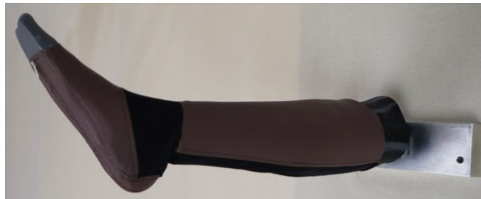
Fig. 5 Prototyp Unterschenkel und Fuß abgedeckt mit Haut-ähnlichem Stoff und elastischem Material im Gelenkbereich
